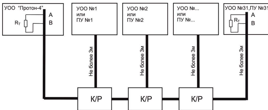
УОО или ПУ - любое устройство или устройство ввода, перечисленный в п. 2.9.8 настоящего РЭ в качестве ведомых по линии интерфейса RS-485 подсистемы «Протон-128».
