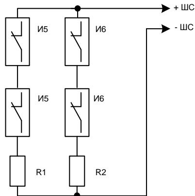
И5 - охранные извещатели с нормально замкнутой цепью. Извещатель, связанный с логическим ШС, для которого выбран метод подключения «ШС X.1».
