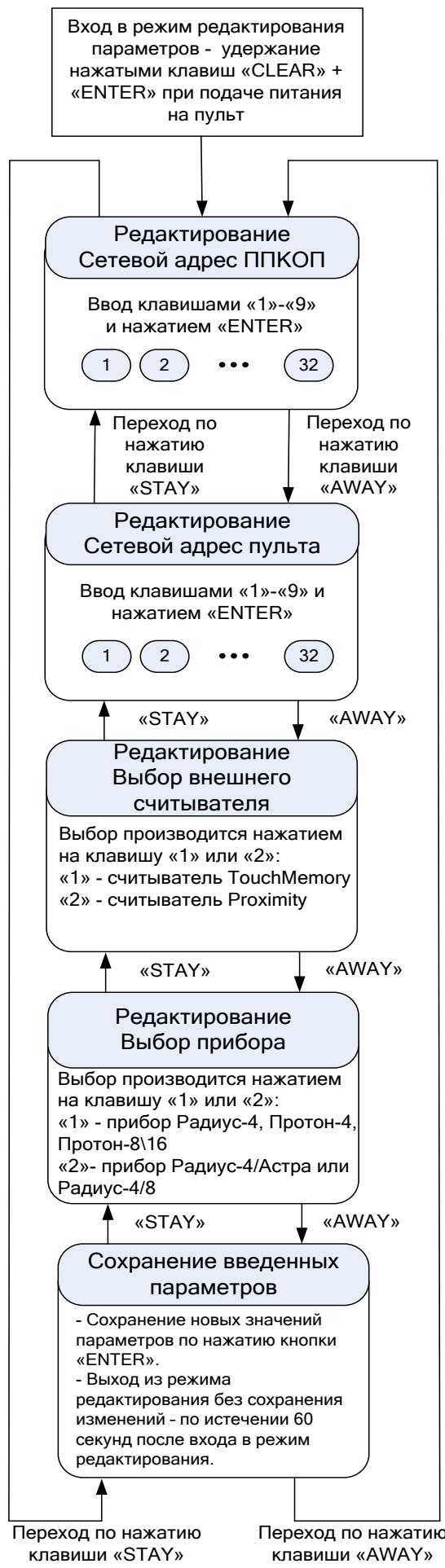
Рисунок 8 – Цикл редактирования параметров пульта.
