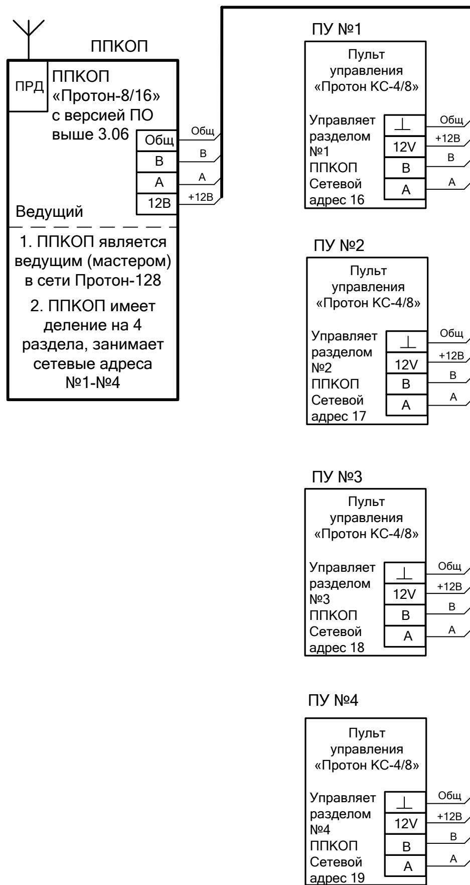
Рисунок 7 – Вариант подключения 4-х пультов к ППКОП «Протон-8/16»
