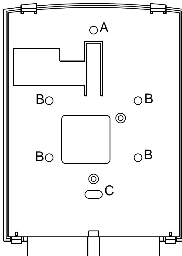
Рисунок В.2 – Крепление основания пульта к стене:
